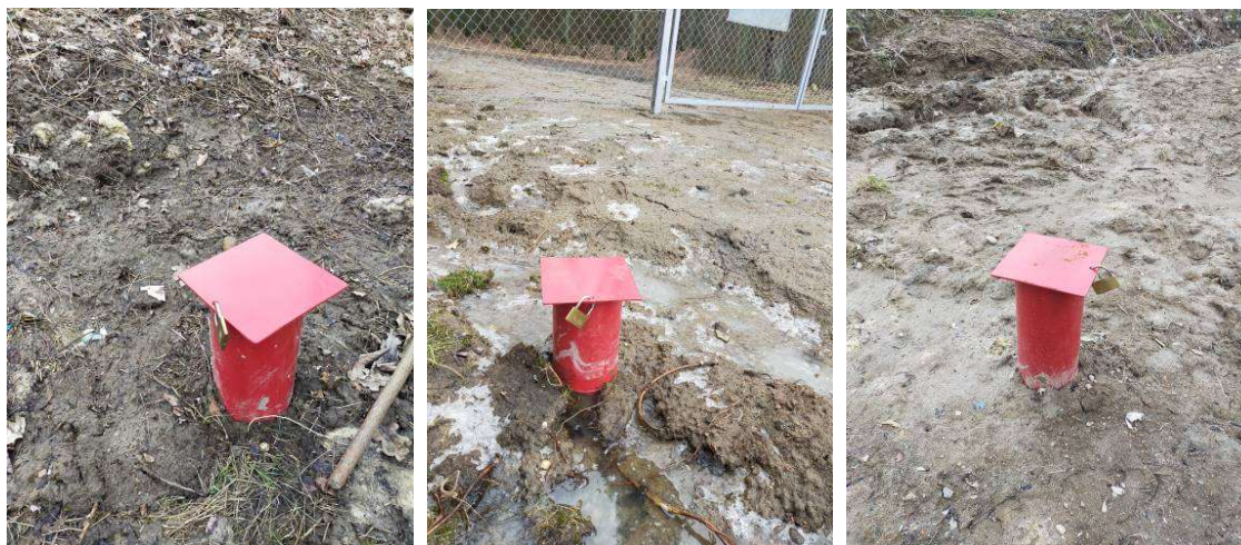
Rysunek 77. Zdjęcie piezometrów zamontowanych w obszarze zrekultywowanego składowiska (Fot. Hubert Zyskowski)
