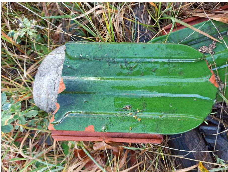
Fotografia nr 9 – Istniejący zachowany fragment pokrycia – dachówka szklwiona na zielono.
